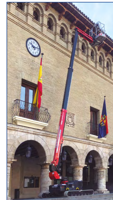
Cesta orugas 16 m Altura 1,35 m cerrada, 2,45 m abierta
