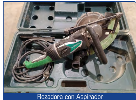
Cortadora Juntas Tanque Agua
